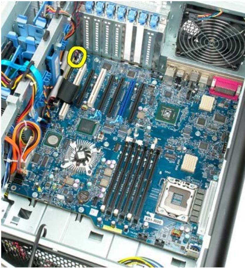
12. Deconectați cablul unității floppy.
